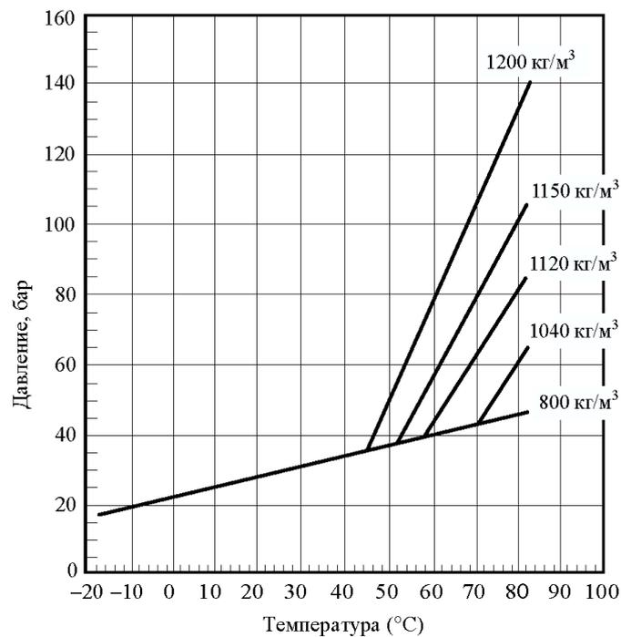
Рисунок А.2 - График зависимости давления в баллоне модуля от температуры для огнетушащего состава HFC 227ea при различных коэффициентах заполнения (кг/м³)
