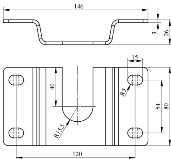
Рисунок 3.8– Кронштейн крепления потолочный типа КРС.І - 2
