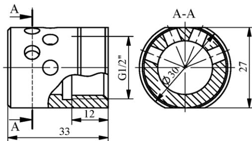
Рисунок 3.16 – Насадок настенного типа с распылом ГОТВ на 180° для модуля типа «Импульс-2-Т»
