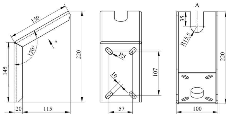
Рисунок 3.11- Кронштейн крепления настенный типа КРН.І - 20
