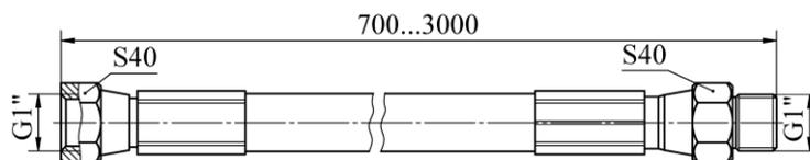
Рисунок 3.15- Рукав высокого давления типа RVT – 25
