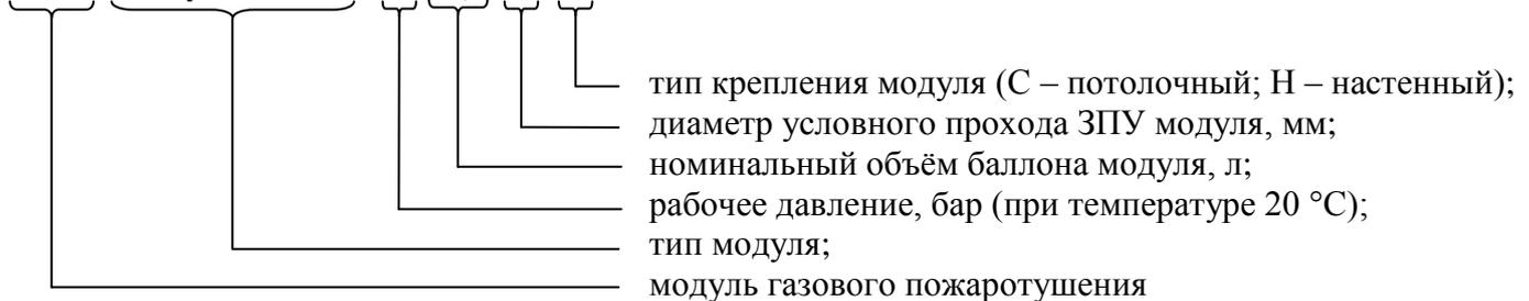
1.2.7 Пример условного обозначения модуля при заказе:
