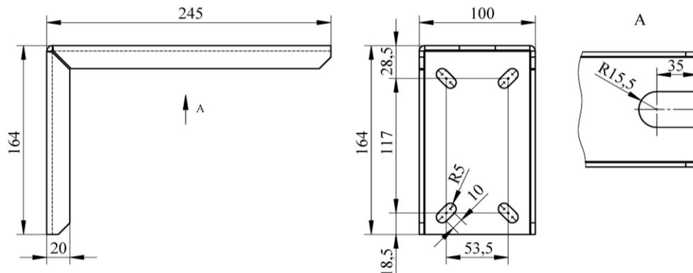
Рисунок 3.13- Кронштейн крепления настенный вертикальный типа КРНВ.І - 20
