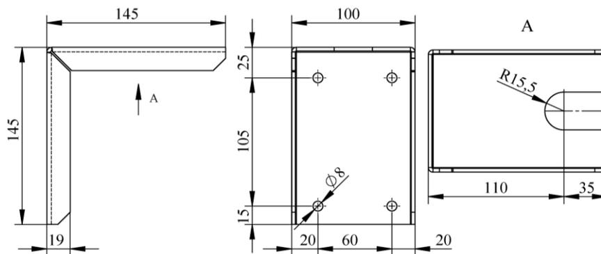
Рисунок 3.12- Кронштейн крепления настенный вертикальный типа КРНВ.І - 2
