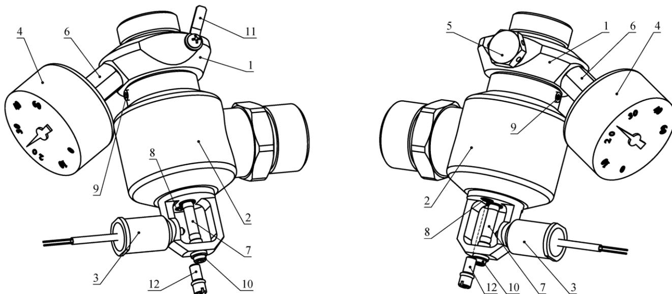
1 – корпус, 2 – корпус выпускного патрубка ЗПУ, 3 – пиротехнический пускатель, 4 – манометр со встроенным реле давления, 5 – предохранительное устройство мембранного типа, 6 – переходник манометра с обратным клапаном, 7 – термочувствительная колба, 8 – транспортный винт, 9 – стопорный винт, 10 – поджимной винт колбы, 11 – клемма заземления, 12 – заглушка транспортного винта
