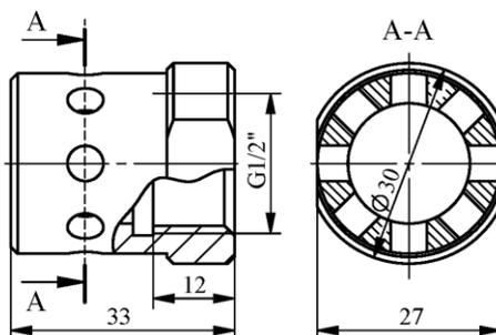
Рисунок 3.17 – Насадок потолочного типа с распылом ГОТВ на 360° для модуля типа «Импульс-2-Т»
