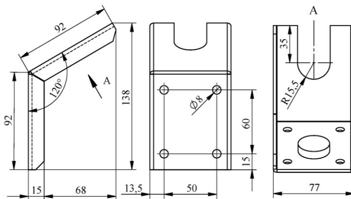
Рисунок 3.10- Кронштейн крепления настенный типа КРН.І - 2
