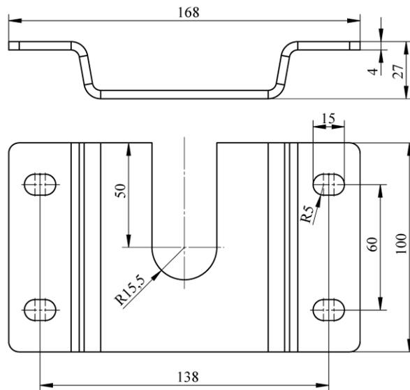
Рисунок 3.9- Кронштейн крепления потолочный типа КРС.І - 20
