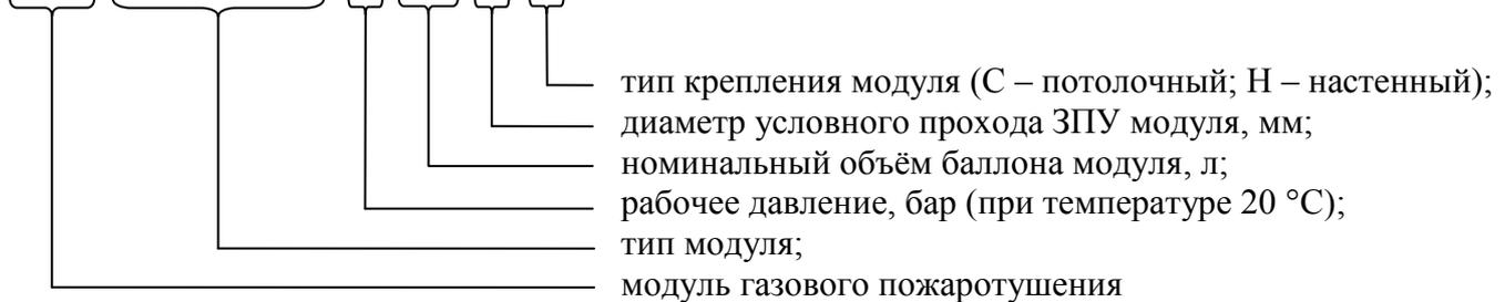
1.2.6 Схема условного обозначения модуля типа «Импульс-2-Т» и «Импульс-20-Т» при заказе:
