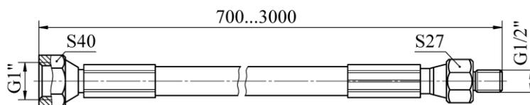
Рисунок 3.14– Рукав высокого давления типа РВД – 16
