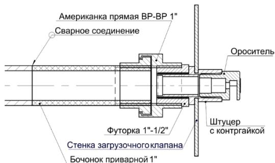
Рисунок 3 – Монтаж оросителя.
